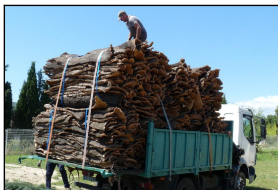
Camion (2 essieux) Vide : 6,3 tonnes Transport Liège : 3,5 à 4 tonnes
