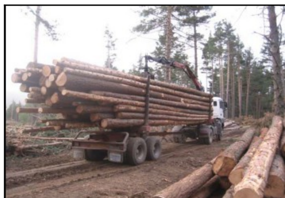
Grumier Vide : 18 à 24 tonnes Transport grumes : 20 à 26 tonnes soit 25 à 30 m3
