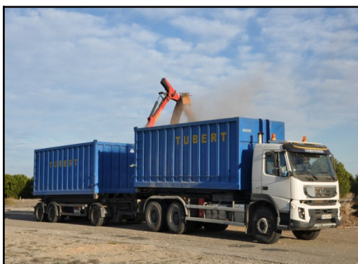
Semi ou Camion remorque polybenne Vide : 13 à 20 tonnes Transport plaquettes : 21 à 29 tonnes Soit 60 à 90 MAP
