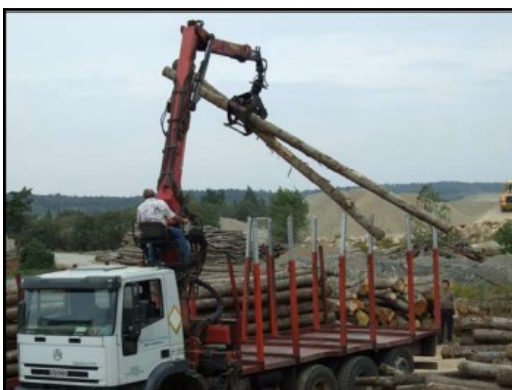
Porteur de type 6/4 Vide : 9 à 13 tonnes Transport bois ronds ou javelles : 17 à 13 tonnes soit 30 stères ou 15 m3
