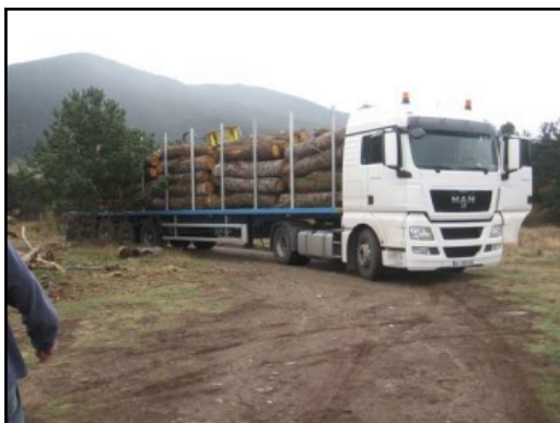
Semi-remorque et camion remorque Vide : 15 à 23 tonnes Transport bois ronds : 21 à 29 tonnes soit 40 à 60 stères
