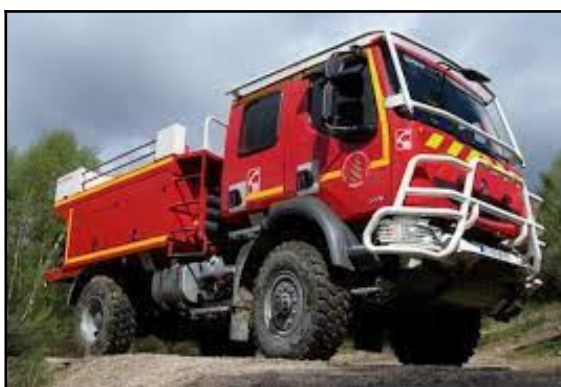
Camion feu de forêt Vide : 9 tonnes Transport 4 à 6 m 3 d'eau
