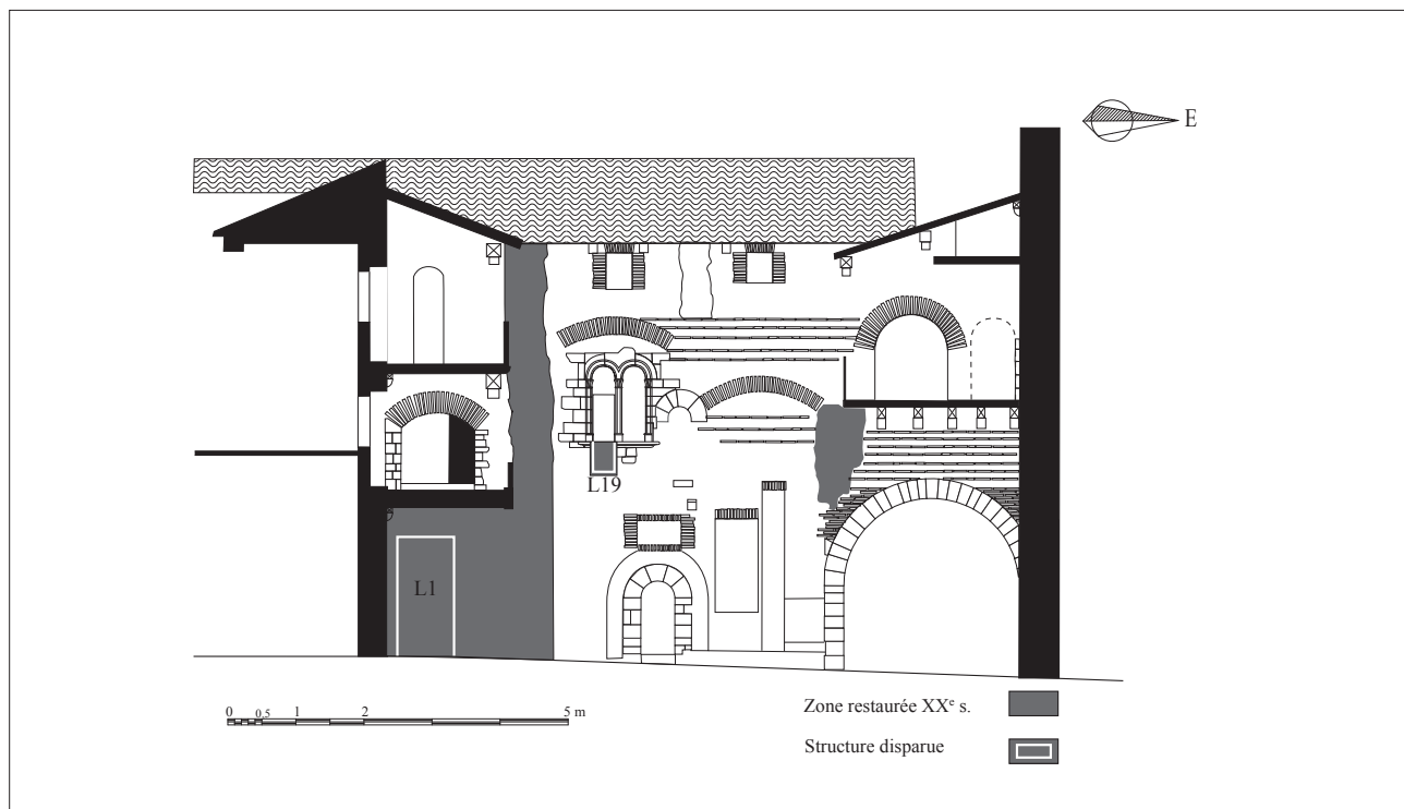
26 - Identification des parties restaurées de la façade de la cour du roi (Agnès Marin, Hadès, 2006).
