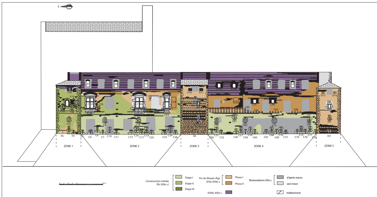
2 - Façade nord de l'aile nord. Exemple de phasage chronologique. Dessin A. Marin et F. Escande. Voir ci-dessous le détail de la tour nord-est.
