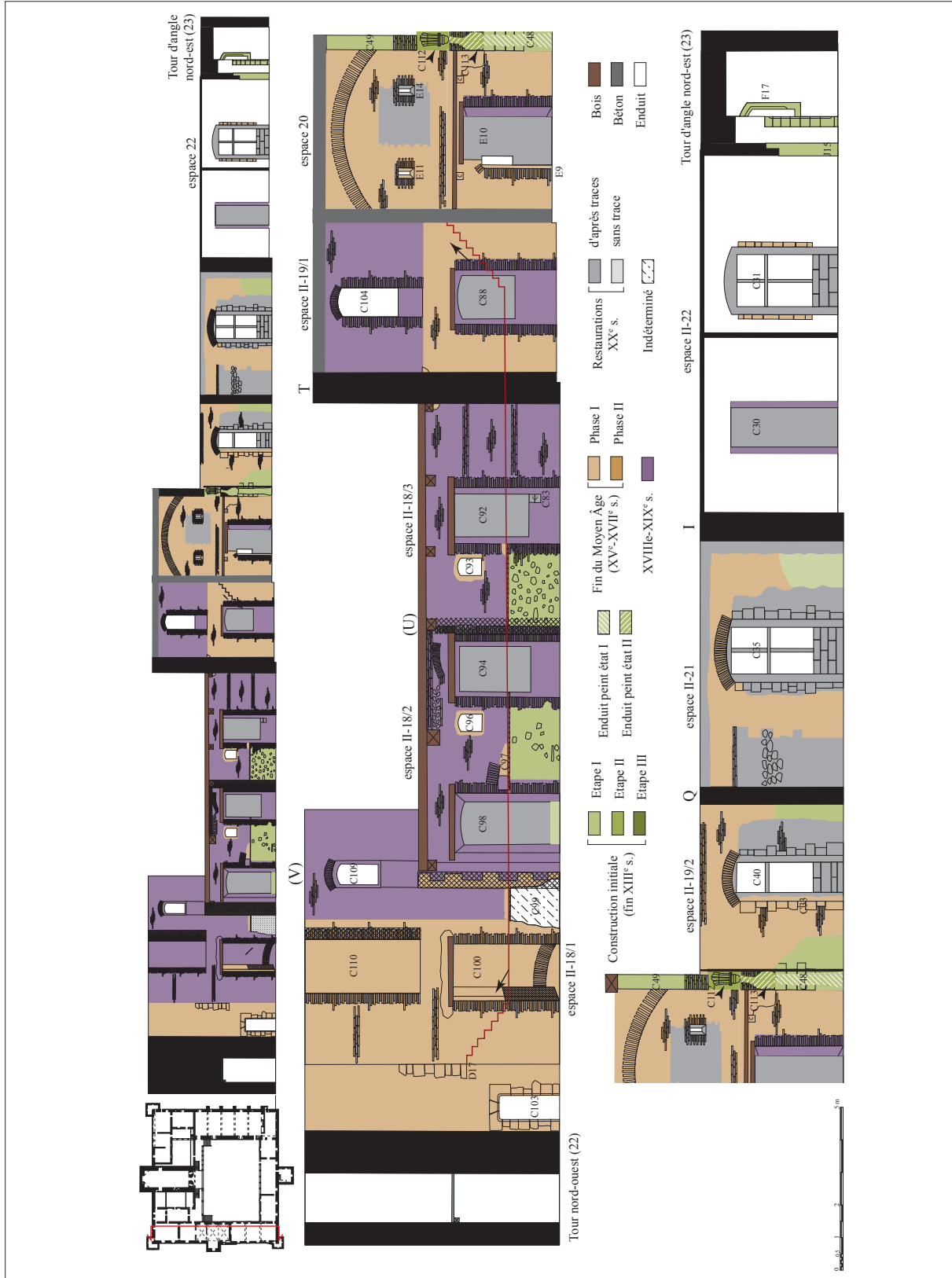
19 - Relevé archéologique phasé du mur intérieur sud, de l'aile nord, premier étage (Agnès Marin, Hadès, 2006).
