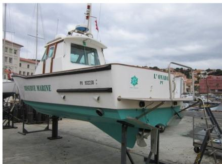
Afin de garder la coque en bon état et permettre l'inspection complète de la partie immergée, une sortie de l'eau est programmée par an. Ainsi la coque a pu être nettoyée et inspectée. Afin de maintenir notre objectif de supprimer l'antifouling de tous les bateaux de la Réserve, la coque n'a pas été repeinte cette année. L'antifouling sera retiré progressivement lors de chaque carénage.
